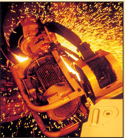
C4010机械手，夹具张开距离0-2200mm (86")，4吨操作能力
