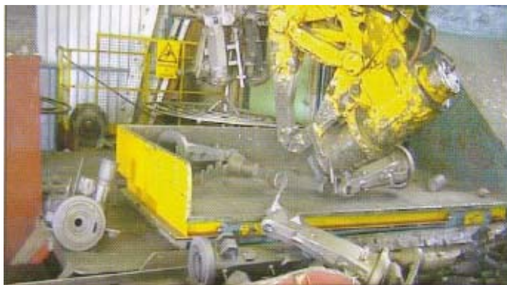
↑ Манипулятор Clansman Dynamics C3010 с пневмомолотом Canon CC100 отбивает литники от отливок
