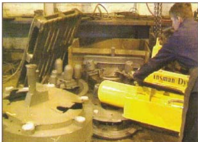
→ Манипулятор Clansman Dynamics с интегрированным пневмомолотом отделяет литниковую систему от отливок
